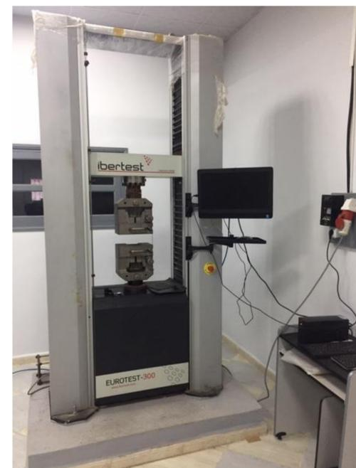
Fig.6: Capacidad de la máquina de ibertest 300KN
