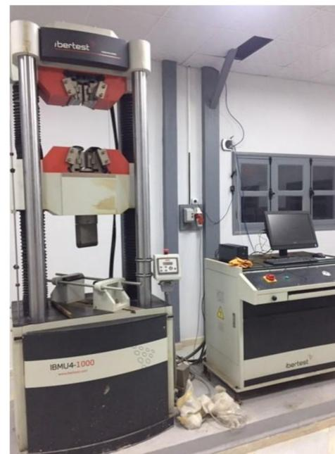
Fig.7: Capacidad de la máquina de ibertest 1000KN
